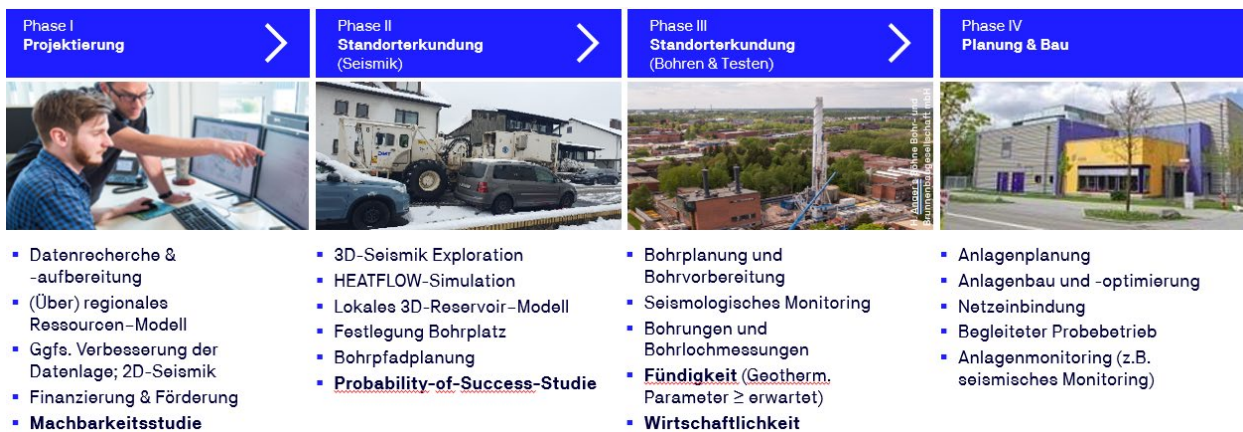
Abb. 2: Projektphasen mit den Arbeitsschritten bei der Tiefengeothermie. Weitere Details beim Leistungsspektrum vom BVEG (2).
