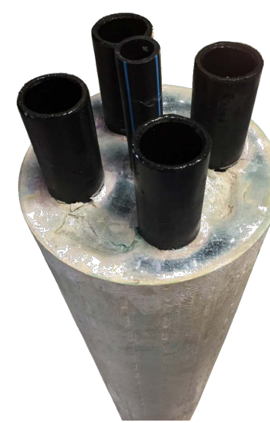
Abbildung 8: Systemprobe (1 m) mit vier Sondenrohren und zentralem Verfüllschlauch. Nach den Messungen sind entlang der Sondenrohrwände Ablösungseffekte erkennbar.
