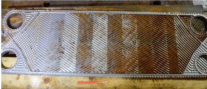
Abb. 6: Foulingrückstände auf Wärmeübertragerplatte nach mechanischer Reinigung
