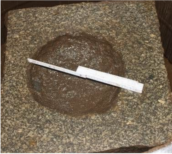
Abb. 4: Bohrloch 12 1/4'' in Granitprobe nach dem Bohrversuch
