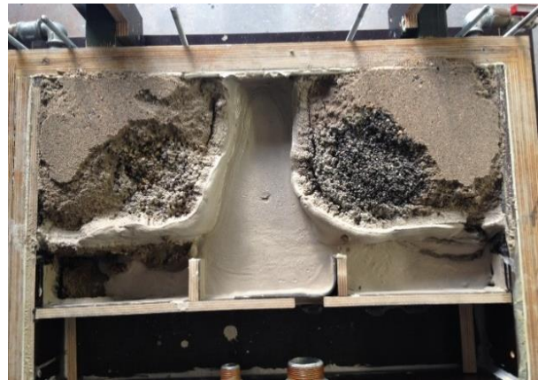
Abbildung 5: Kastenversuch zur Visualisierung des Filtrationsverhaltens von Erdwärmesondenverfüllsuspensionen (links: Einfüllen von Formation und Suspension; rechts: Filterkuchen nach Druckbeaufschlagung mit 1 bar Druck)
