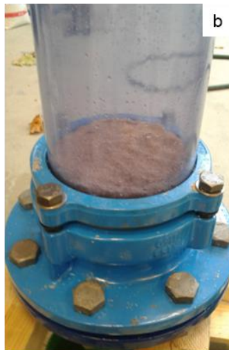
Abbildung 5: Kastenversuch zur Visualisierung des Filtrationsverhaltens von Erdwärmesondenverfüllsuspensionen (links: Einfüllen von Formation und Suspension; rechts: Filterkuchen nach Druckbeaufschlagung mit 1 bar Druck)
