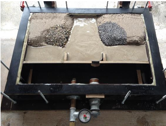
Abbildung 5: Kastenversuch zur Visualisierung des Filtrationsverhaltens von Erdwärmesondenverfüllsuspensionen (links: Einfüllen von Formation und Suspension; rechts: Filterkuchen nach Druckbeaufschlagung mit 1 bar Druck)
