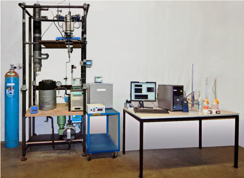
Abb. 1: Hochdruck-Hochtemperatur-Säulenapparatur
