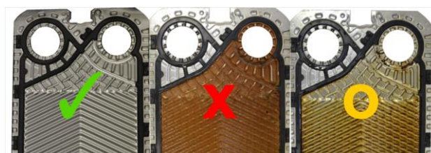
Abb. 7 Gegenüberstellung einer unbenutzten, verschmutzten und gereinigten Wärmeübertragerplatte
