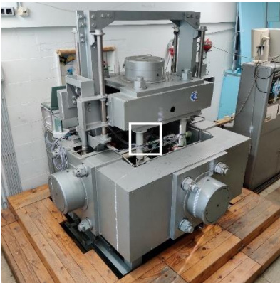
Abb. 1: Links: Die an der CAU Kiel genutzte Würfelpresse. Mitte: Eine schematische Darstellung der Probe (orange) und der sechs Druckstempel (grau) unter 3D Spannungsbelastung. Rechts: Schematische Darstellung der Durchschallung mit P- und S-Wellen des Probewürfels.
